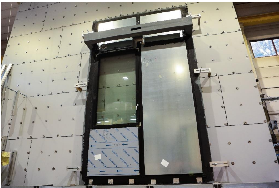
'Lucht-water-wind'-proefpost voor het karakteriseren van de dichtheid van grote bouwelementen.
