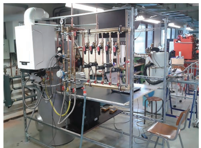
1 | Proefopstelling voor het meten van de SWW-productierendementen volgens het Ecodesignprincipe
