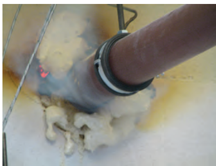
Afb. 1 De afdichting van een buis met een schuim zonder brandprestaties heeft slechts weinig zin, vermits de brandweerstand niet gewaarborgd wordt.
