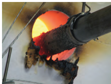
Afb. 1 De afdichting van een buis met een schuim zonder brandprestaties heeft slechts weinig zin, vermits de brandweerstand niet gewaarborgd wordt.
