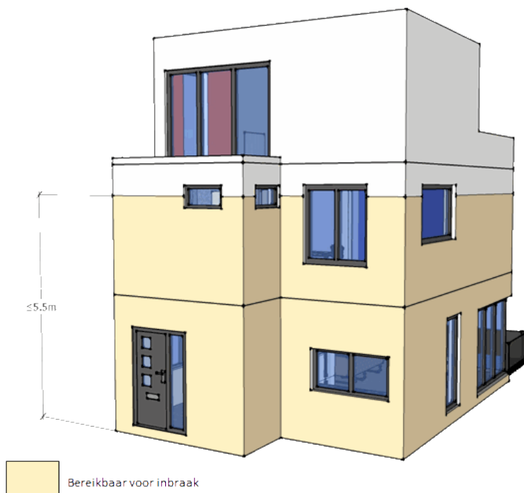
Figuur 1 Bereikbaarheid voor inbraak in de uitwendige scheidingsconstructie volgen NEN 5087:2013
