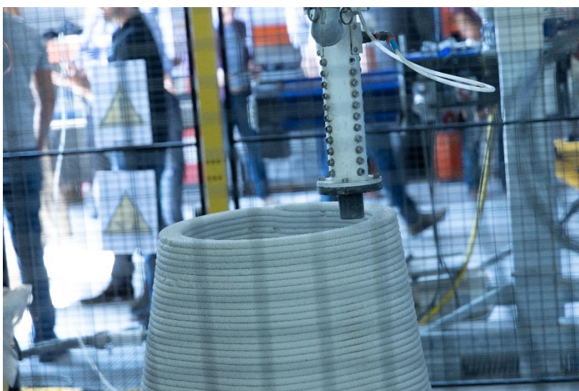
Fig. 1 : Gebruik van 3D-printing als voorbeeld om productie te automatiseren
