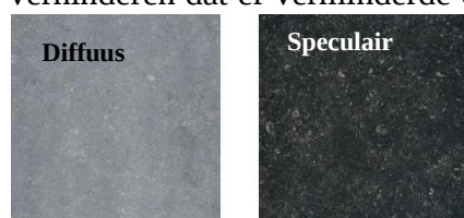
FIGUUR 54: HETZELFDE RESULTAAT BIJ KLEURMETING, MAAR EEN VERSCHILLENDE UITZICHT – MEETGEOMETRIE: D65, 10°, D/8°, SCI
