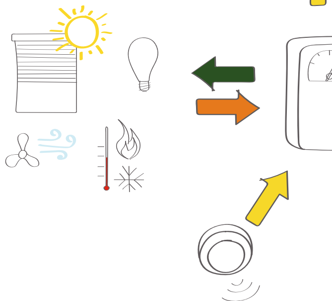
Exemple du principe de fonctionnement d'un système de gestion du bâtiment.
