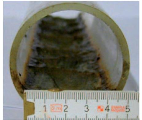
Fig. 4 Dépôt après 9 mois dans un conduit de diamètre DN 50 mm.
