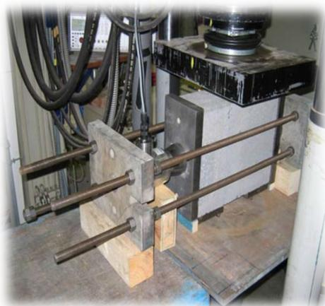
Utiliser des charges de précompression permettant d'obtenir des contraintes de 0,2 N/mm<sup>2</sup>, de 0,6 N/mm<sup>2</sup> et de 1,0 N/mm<sup>2</sup> pour des éléments dont la résistance à la compression > à 10 N/mm<sup>2</sup> et des charges de 0,1 N/mm<sup>2</sup>, 0,3 N/mm<sup>2</sup> et de 0,5 N/mm<sup>2</sup> pour une résistance < 10 N/mm<sup>2</sup>.
