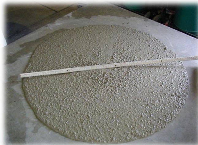
Figure 1: Photo de la mesure d'étalement d'un béton
