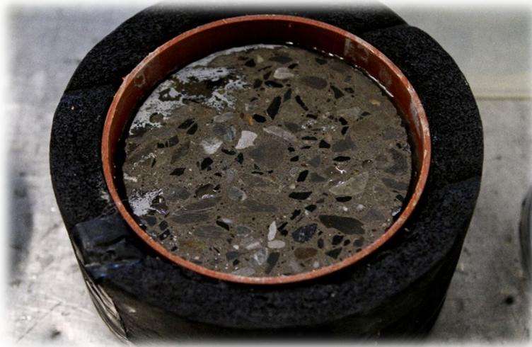
Figure 2: Echantillon recouvert d'un film en caoutchouc et d'une isolation thermique
