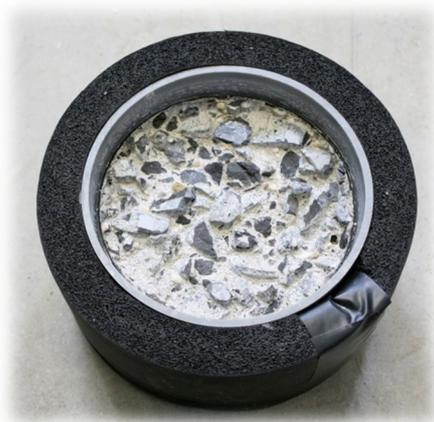
Figure 4: Echantillon avec géométrie et enrobage dévié, qui a été soumis à des cycles de gel-dégel
