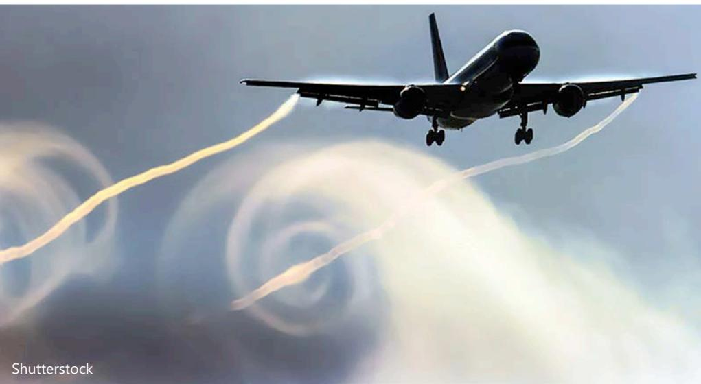
1 | An den Enden der Tragflügel und der Landeklappen von Flugzeugen entstehen Wirbelwinde.
