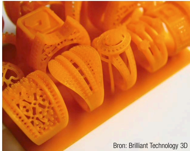
3 | Voorbeeld van een 3D-geprint verlorenwasmodel voor juwelen dat een zeer grote precisie en complexiteit toelaat
