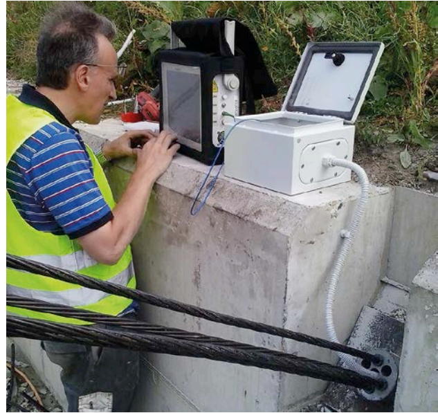
4 | Meetkast voor de langetermijnmonitoring van de vervormingen van de strengen uit voorspanstaal
