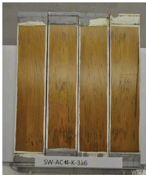
3 | Fotodegradatie van het hout die gepaard gaat met de ontwikkeling van schimmels waardoor er donkerdere zones ontstaan.
