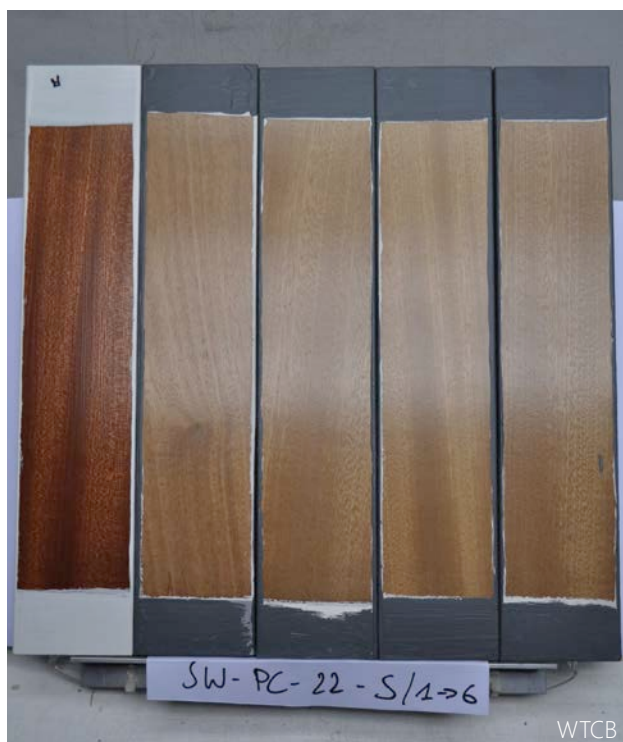
2 | Uitzichtverandering die vooral toe te schrijven is aan een evolutie van het hout. In dit geval werd er een beits met een lichte eikenkleur op sapelli aangebracht. Het linkerproefstuk is het referentiestaal zonder veroudering.
