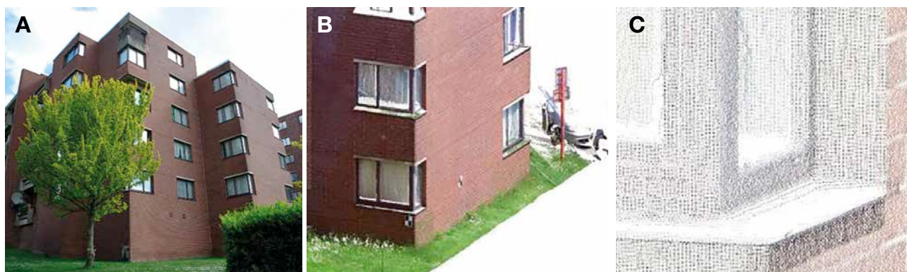
1 | A. Gebäude, das man in 3D digitalisieren möchte. B. 3D-Modell, das vom Gebäude mithilfe des Laserscanners generiert wurde. C. Zoom auf das Modell, das aus Tausenden von Punkten gebildet wird.
