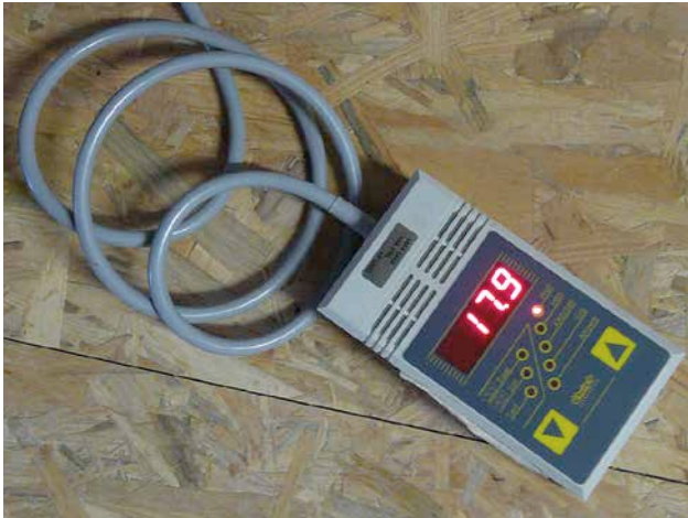
2 | Messung der aufgenommenen elektrischen Leistung mit einem Leistungsmessgerät.
