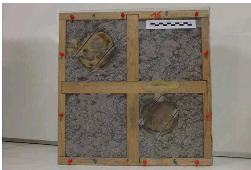
3 | Stark angegriffenes Modell mit Zellulosewolle ,4-6' (Behandlung mit Borsalzen und Magnesiumsulfat).
