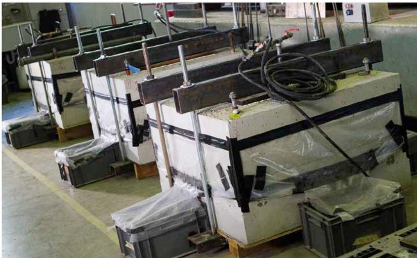
2 | Wasserbelastung, die einer Wassersäule von 3 m entspricht, und Verfolgung des Leckvolumenstroms.
