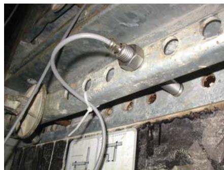
Abb. 2 Anbringung eines kleinen Drucksensors.
