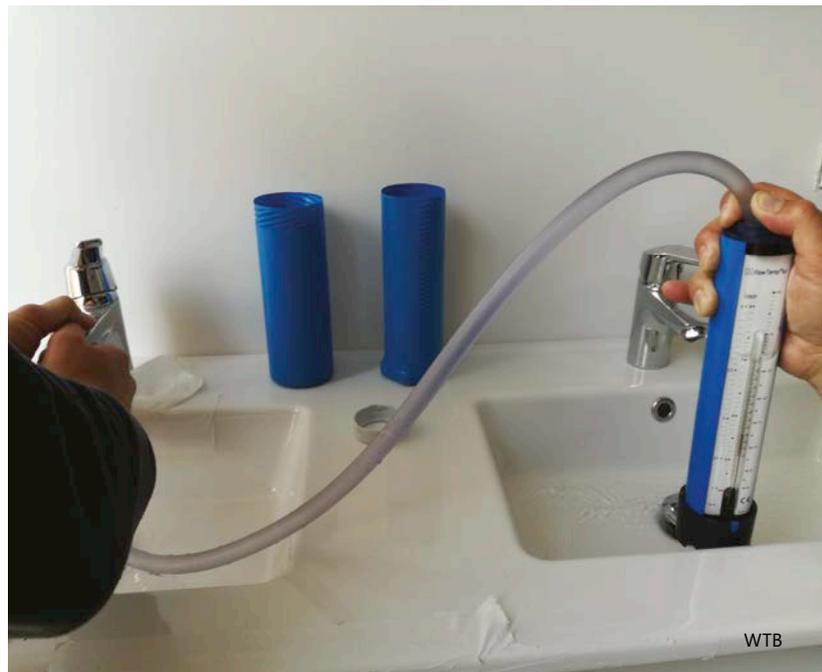
2 | Messung des Spülvolumenstroms an einer Entnahmestelle.
