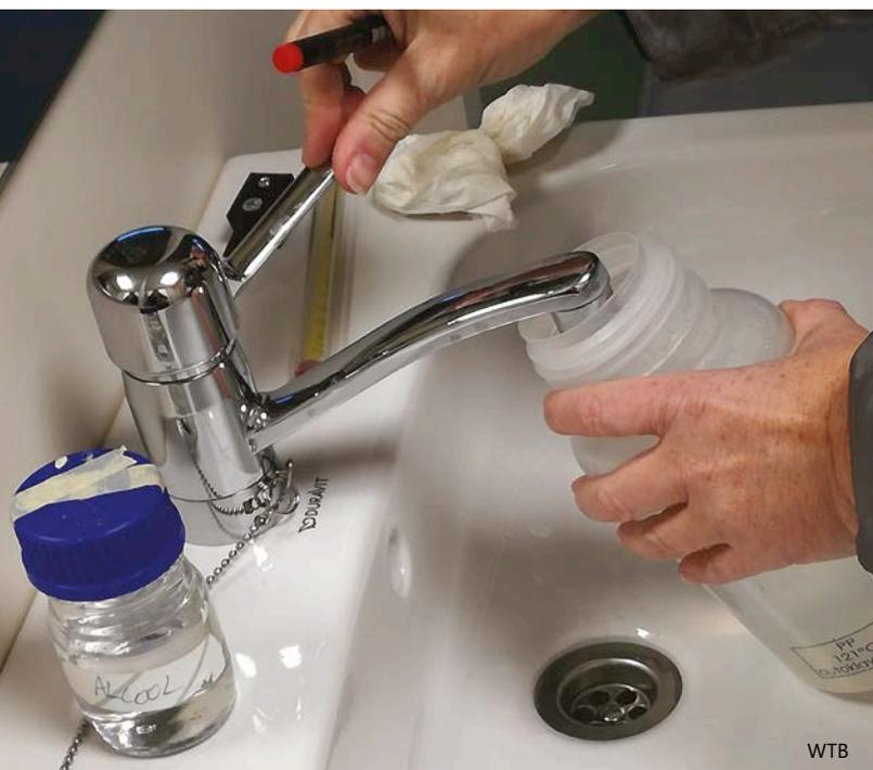
1 | Probeentnahme an einem Waschbecken nach dem Spülen.
