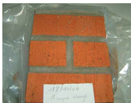
Durchführung des Tests auf orangem Backstein ohne Auftreten von Ausblühungen.
