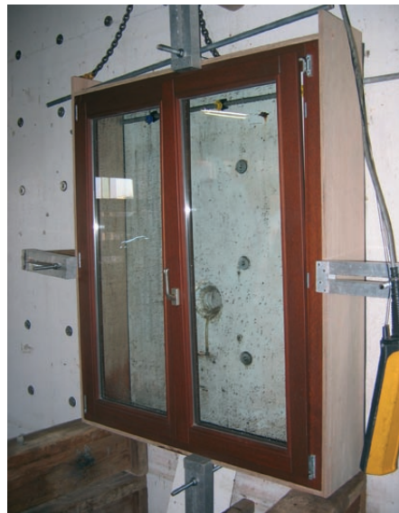
Versuchsaufbau zur Bewertung der Luft- und Wasserdichtheit eines Fensters.
