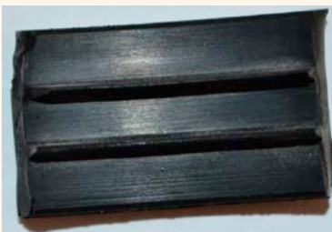
1 | EPDM vor der Prüfung
