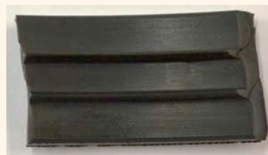
5 | Mit Geschirrspülmittel eingeschmiertes EPDM nach der Prüfung
