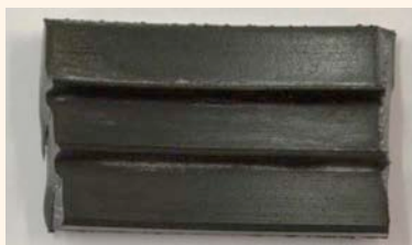
4 | Mit Schmierseife eingeschmiertes EPDM nach der Prüfung
