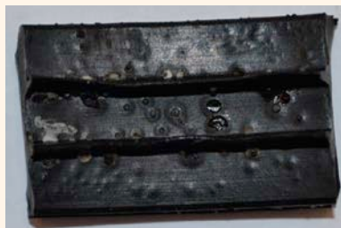
2 | Mit Fett eingeschmiertes EPDM nach der Prüfung
