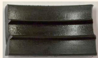
3 | Mit Silikon eingeschmiertes EPDM nach der Prüfung
