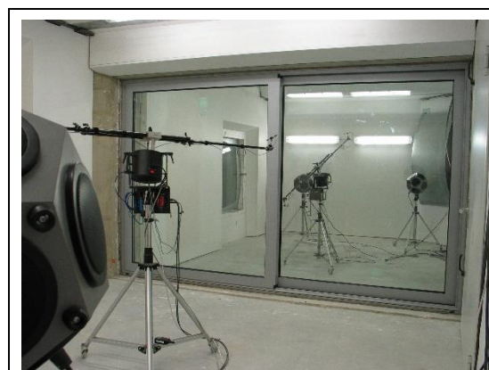
Figure 1 Détermination de l'indice d'affaiblissement acoustique R en laboratoire selon NBN EN ISO 10140-2.
