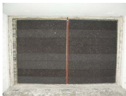
Bepaling van de luchtgeluidsisolatie ( DL_R ).
