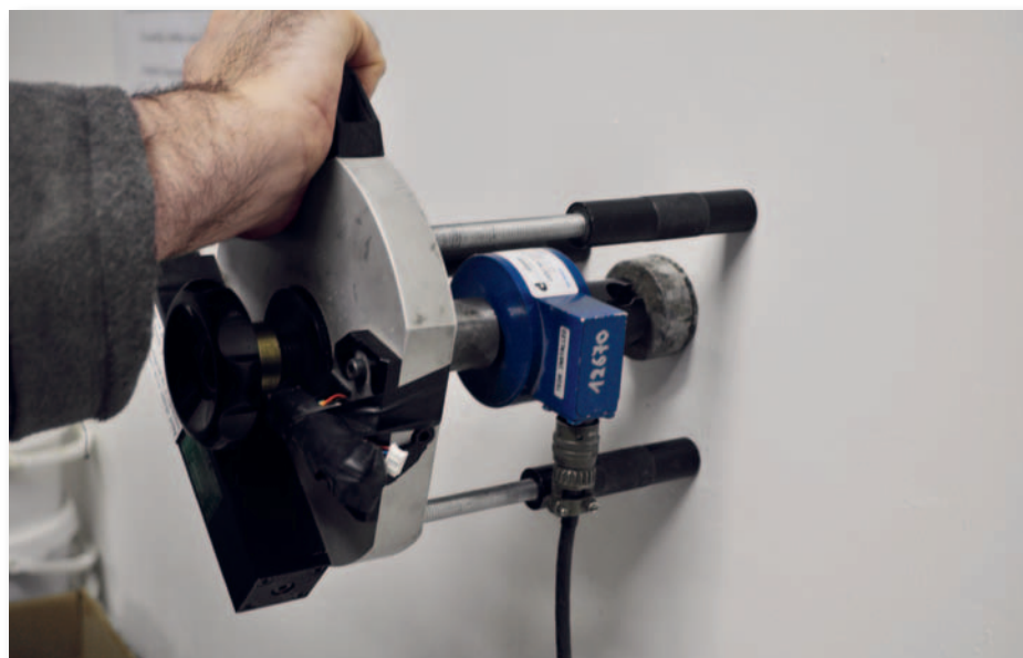
Afb. 4 Afbreekproef volgens de norm NBN EN 1504-2
