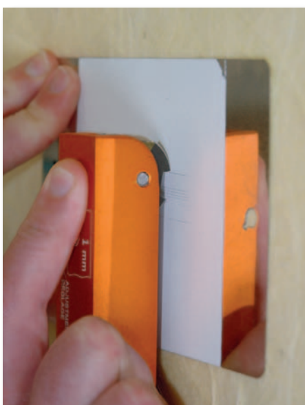
Afb. 1 en 2 Voorbeelden van insnijdingen met een geleider voor de ruitjesproef
