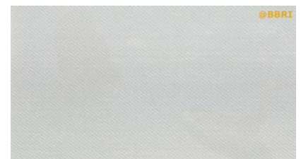
Doek D – Binding: sergé Kleur: wit - \rho_v : 0,74 Openingsfactor O_p : 3 % Klasse van visueel contact met de buitenomgeving: 0 Zontoetreding \tau_e : 0,19
