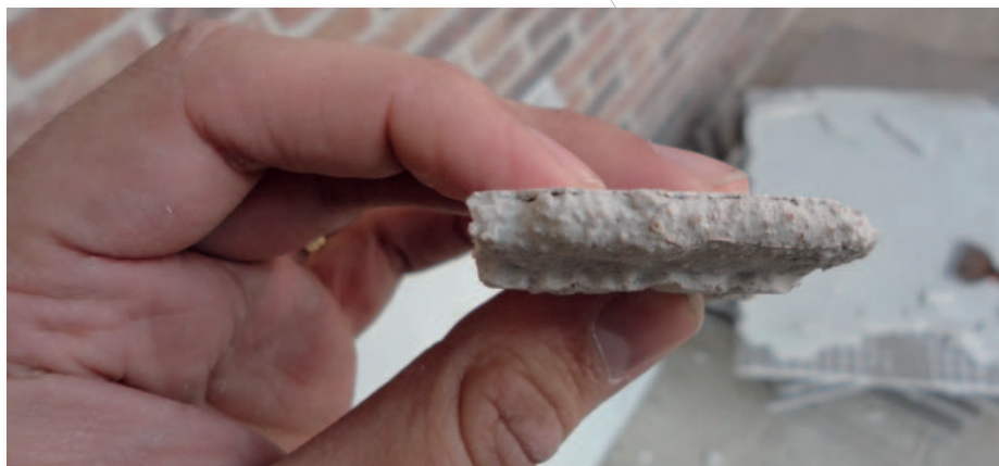
Abb. 1 An dem Kleber einer Fliese haftender Zementmilchfilm.
