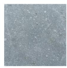
Calcaire de teinte bleue présentant sporadiquement des crino $\ddot{}$  des blancs. Des veines de calcite de 1 à 3 mm de large parcourent la pierre suivant une direction déterminée.
