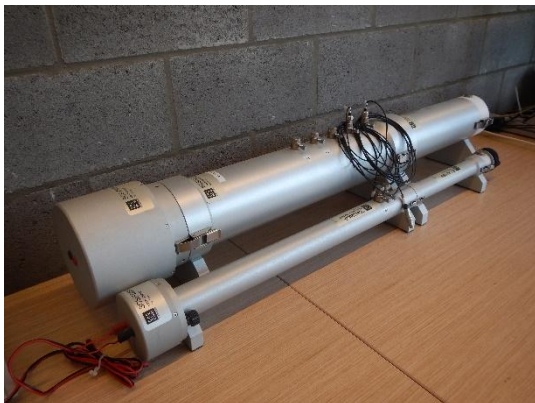
Afb. 1 Bepaling van de absorptiecoëfficiënt \alpha voor loodrechte geluidsinval in de buis van Kundt volgens NBN EN ISO 10534.
