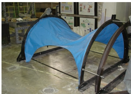
Afb. 3 Uitvoering van een dubbelgekromde schaalstructuur met spuitbeton.
