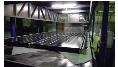
Fig. 1 Caisson d'essai pour la détermination de la résistance au vent des toitures plates.
