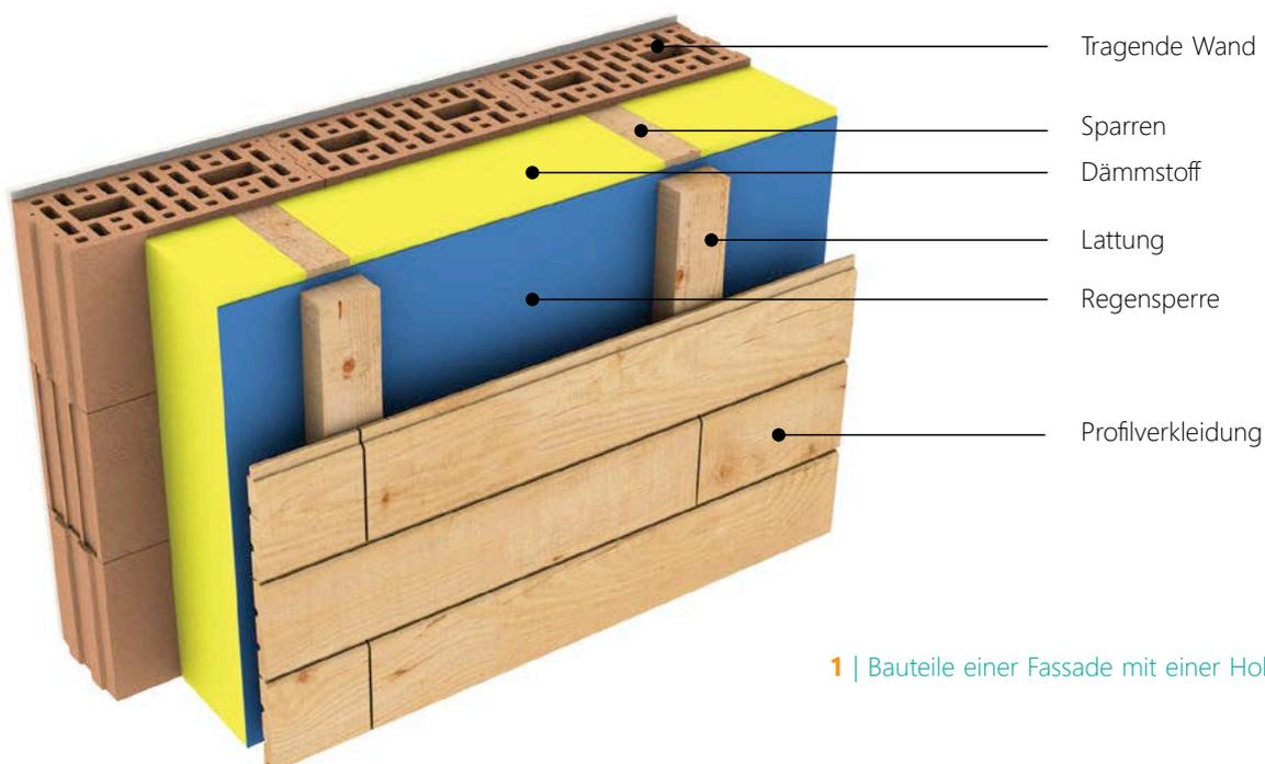
1 | Bauteile einer Fassade mit einer Holzprofilverkleidung.
