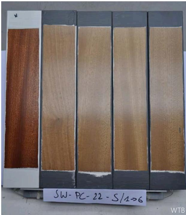
2 | Veränderung des Aussehens, die hauptsächlich auf eine Entwicklung des Holzes zurückzuführen ist. In dem Fall wurde eine Lasur mit einem hellen Eichenfarbton auf Sapelli aufgetragen. Der linke Prüfling ist die Referenzprobe ohne Alterung.
