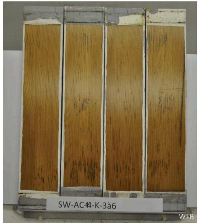
3 | Photochemischer Abbau des Holzes in Verbindung mit der Entwicklung von Schimmelpilzen, was dunklere Bereiche anstehen lässt.
