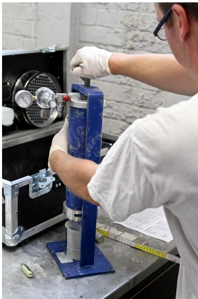
Figuur 5: Meting van de waterafscheiding d.m.v. de Bauer test
