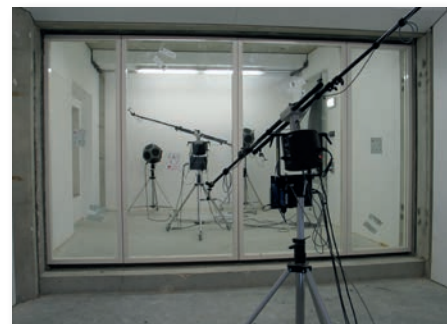
Fig. 3 Nouveau système de mesure multicanaux et paroi en test
