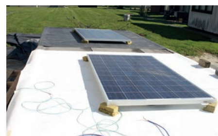
Influence d'une membrane blanche sur la température de panneaux PV en surimposition
