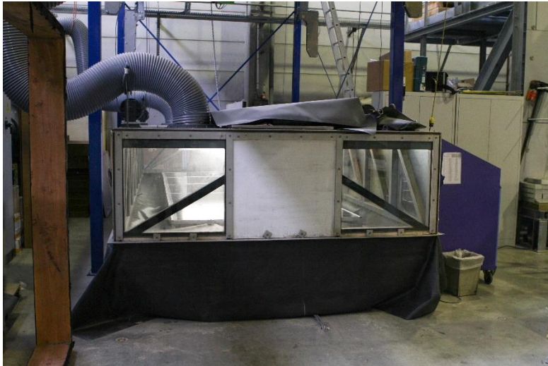
Résistance au vent des toitures plates.
