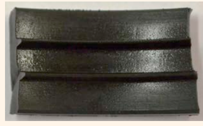
3 | Met siliconen ingesmeerd EPDM na de proef
