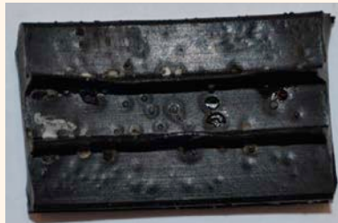
2 | Met vet ingesmeerd EPDM na de proef
