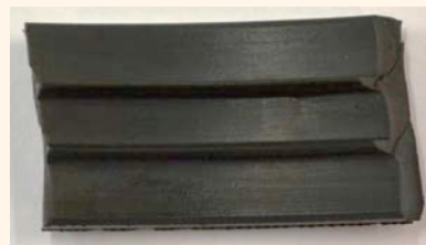
5 | Met vaatwasdetergent ingesmeerd EPDM na de proef
