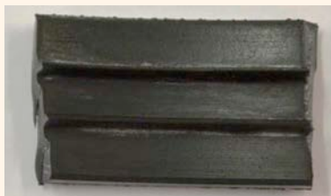
4 | Met bruine zeep ingesmeerd EPDM na de proef
