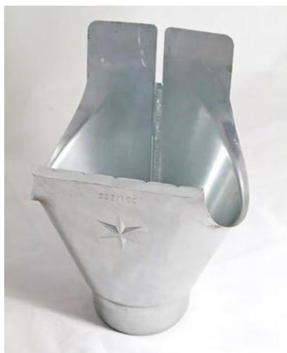
1 | Uitlooptrechter met een afvoeropening met een diameter van 100 mm voor een half-ronde goot met een ontwikkelde breedte van 333 mm
