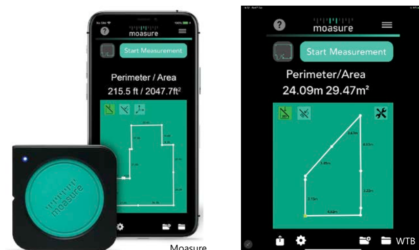
2 | Ausmessen und Visualisieren der Fläche eines Außenhofs mit der Applikation ‚Moasure‘ und dem dazugehörigen externen Sensor (300 $ im Jahr 2019).
