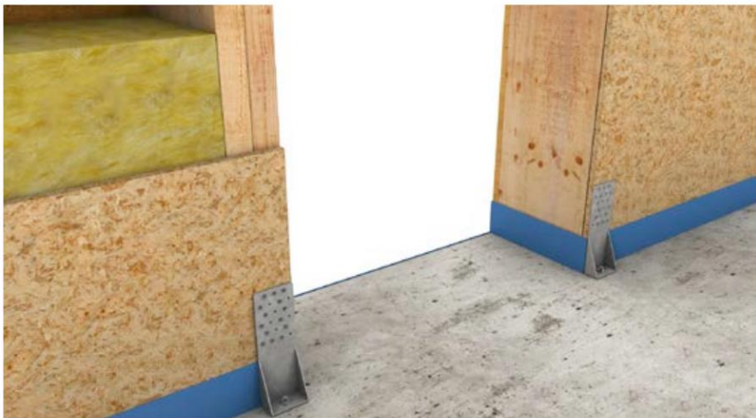
Fig. 7.6 Équerre spécifique anti-arrachement permettant de reprendre des efforts de soulèvement importants.
