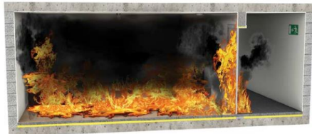
4 | Propagation de l'incendie au compartiment adjacent.
