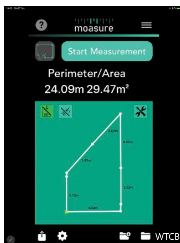
2 | Opmeten en visualiseren van de oppervlakte van een buitenkoer met de 'Moasure'-applicatie en de bijhorende externe sensor ($ 300 in 2019).
