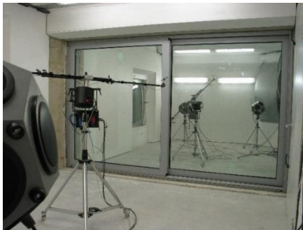
Fig. 1 Détermination de l'indice d'affaiblissement acoustique R en laboratoire selon NBN EN ISO 10140-2.
