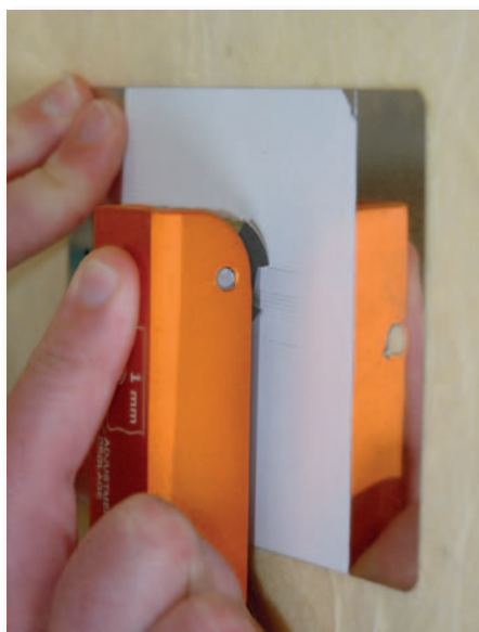
Abb. 1 und 2 Beispiel für einen mit einer Führung durchgeführten Gitterschnitt.
