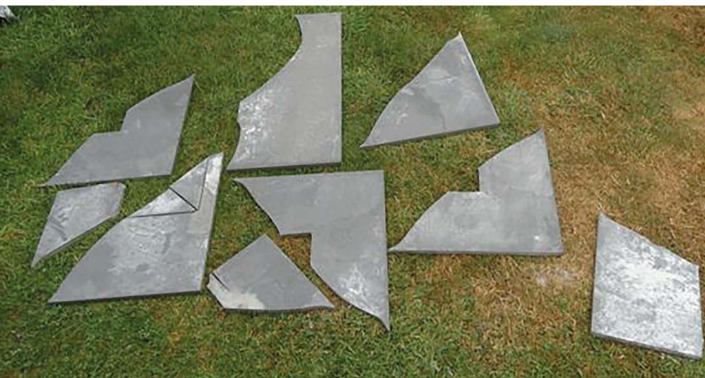
1 | Beispiel für einen willkürlichen Bruch bei keramischen Fliesen
