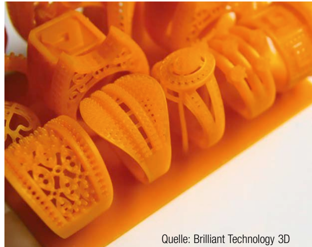
3 | Beispiel für ein 3D-gedrucktes Wachsaußschmelzmodell für Juwelen, das eine sehr große Präzision und Komplexität gestattet
