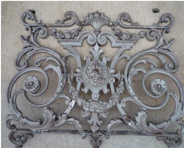
2 | Beispiel für einen komplexen gusseisernen Gegenstand, von dem die Sandform in 3D gedruckt werden könnte
