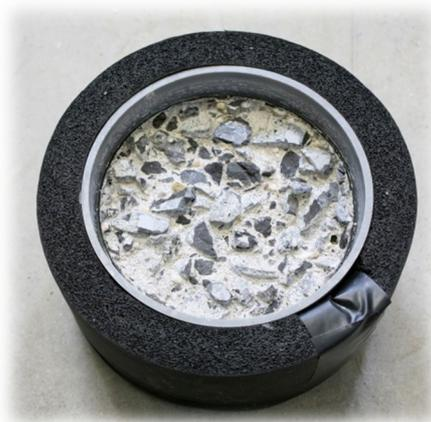
Figure 4: Echantillon avec géométrie et enrobage dévié, qui a été soumis à des cycles de gel-dégel
