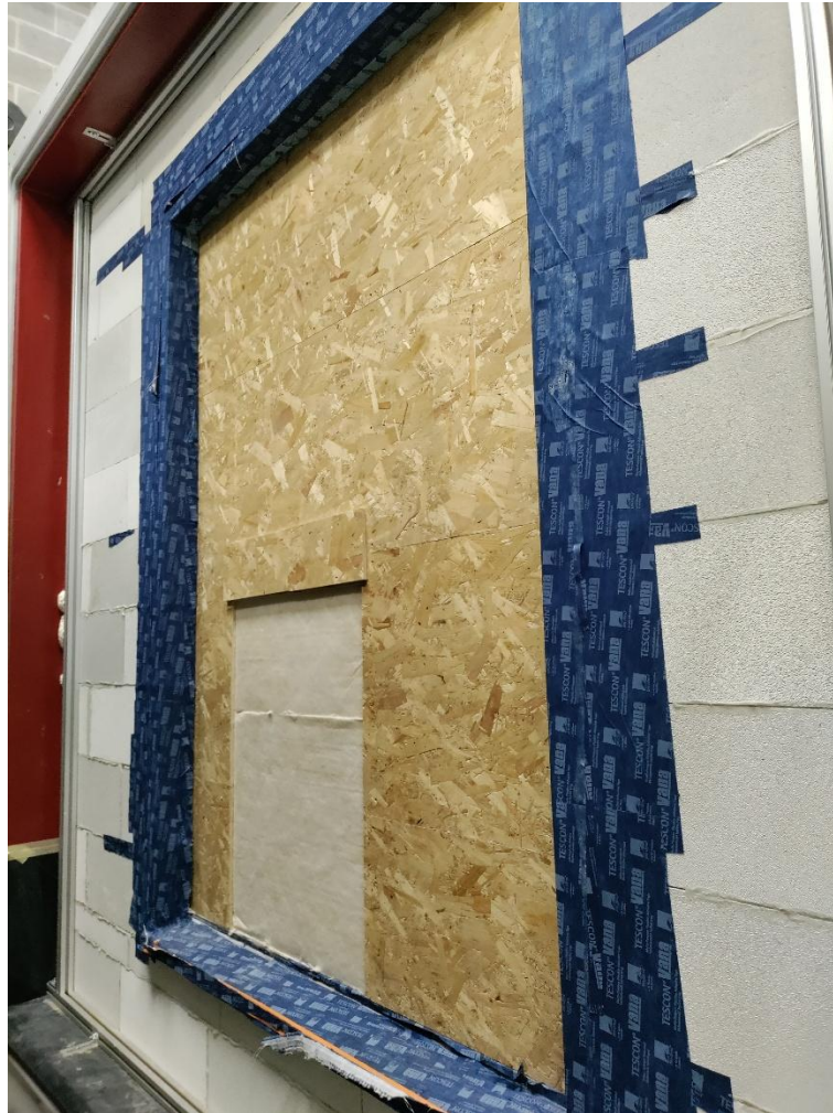
FIGURE 8. CADRE DE TEST POUR LEQUEL LA FENÊTRE A ÉTÉ REMPLACÉE PAR DE L'ISOLANT
