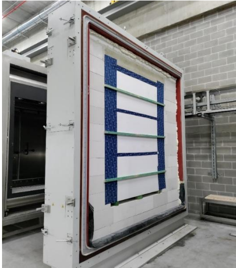
FIGURE 5. CADRE DE TEST POUR LEQUEL LA FENÊTRE A ÉTÉ REMPLACÉE PAR DE L'ISOLANT
