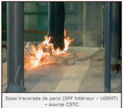
Essai traversée de paroi (SPF Intérieur - UGENT) - source CSTC
