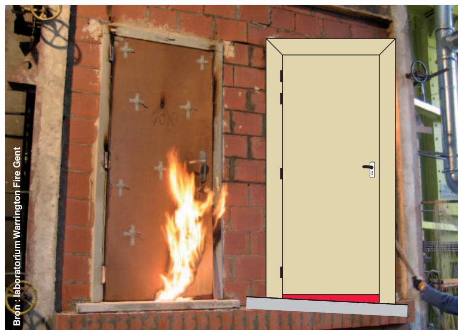
Afb. 1 Horizontaliteits- en/of vlakheidsafwijking in de vloer ter hoogte van de gesloten brandwerende deur en branddoorgang
