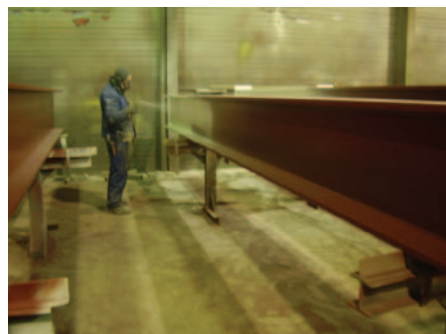
Afb. 1 Aanbrengen van de primer met een pistool.
