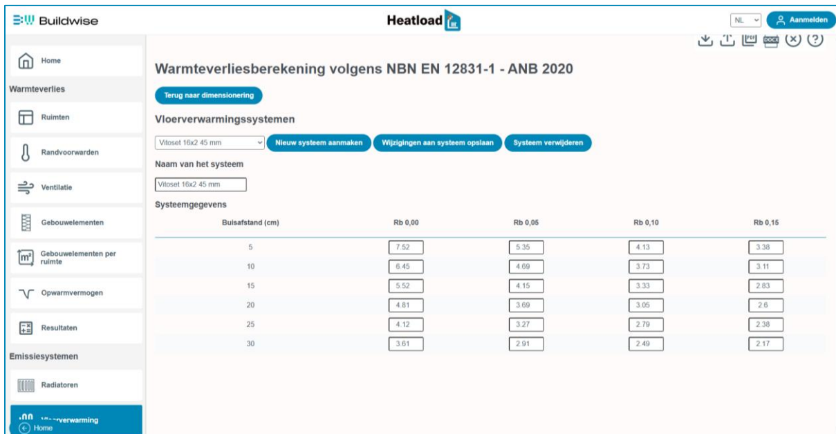
Figuur17 K_H -waarden voor een vloerverwarmingssysteem (voorbeeld)
