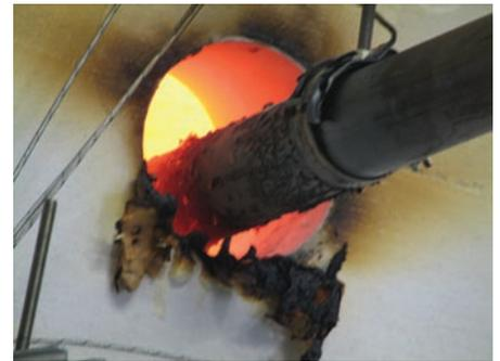
**Abb. 1** Die Abdichtung eines Rohres mit einem Schaum ohne Brandleistungen hat nur wenig Sinn, da die Feuerfestigkeit nicht gewährleistet werden kann.
