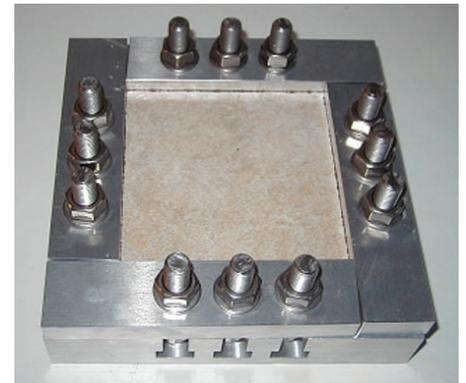
**Abb. 2** Entsprechend dimensionierter Metallrahmen zur Reproduzierbarkeit der wirklichen Blockierungen.
