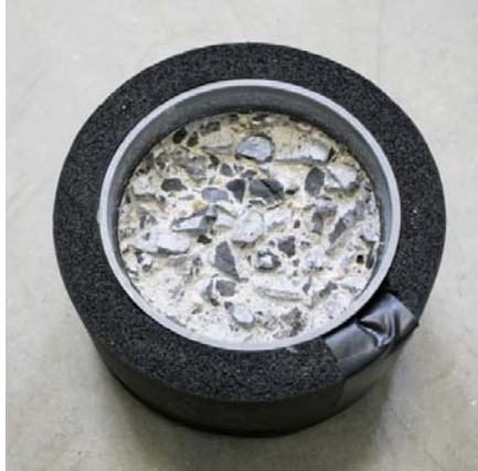
Figuur 3: Proefstuk met afwijkende geometrie en omhulling, dat onderworpen is geweest aan vorst-dooicycli.
