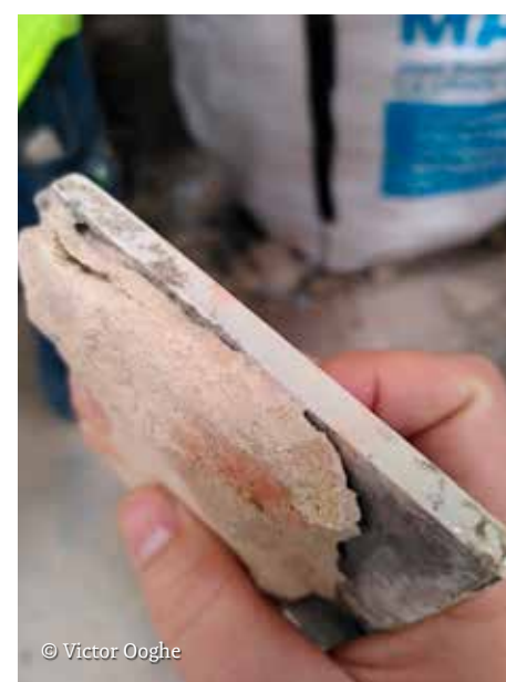
Usquare Brussel - oude venstertabletten verwerkt in de terrazzvloer
