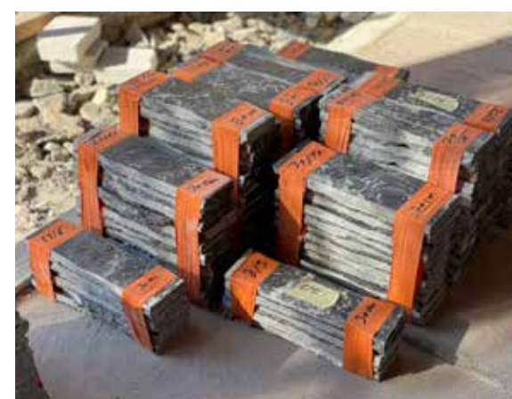
Usquare Brussel - oude venstertabletten verwerkt in de terrazzvloer
