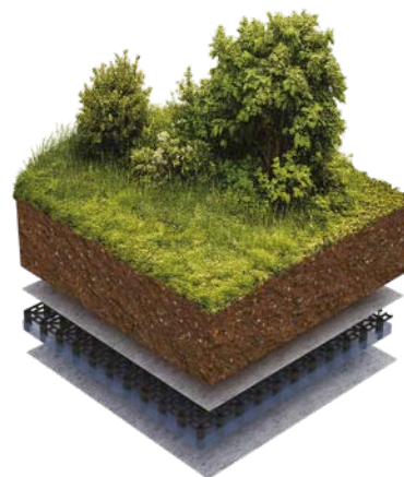
Toiture à rétention d'eau
