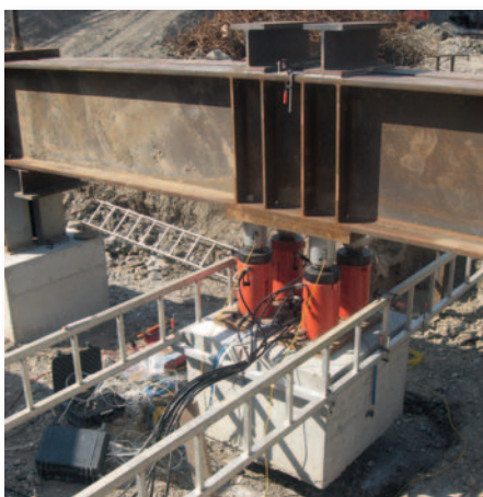
Principeschema van de impulsmethode en voorbeeld van een statische paalbelastingsproef
