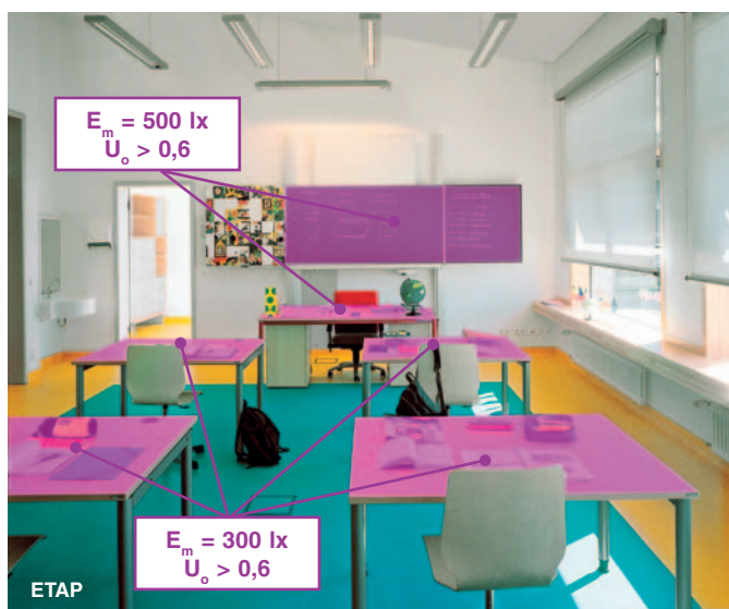
Te verzekeren verlichtingssterkte en uniformiteit van de verlichting in een klaslokaal
